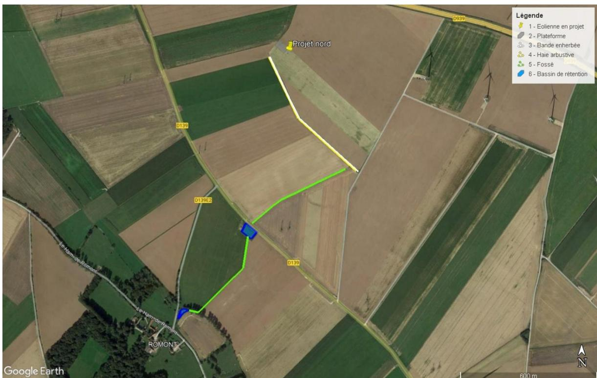
*Le projet prévoit de faire passer le chemin d'accès à la plateforme le long de la haie, sur son côté nord-est, sur la bande enherbée, large de 5,5 m. La largeur du chemin serait de 4 m, au moins pour la durée des travaux de montage qui nécessitent le passage d'engins lourds (grues, camions de transports exceptionnels).*
